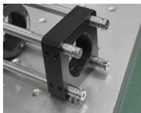
取付部材を所定位置に移動し皿ネジを締めて固定、穴と軸が自動芯出しされます
